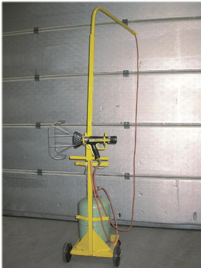
Muni d'une potence abritant le tuyau d'alimentation, ce chariot porte bouteille de gaz (13 ou 35 kg) est équipé de 4 roulettes (2 fixes, 2 mobiles).
