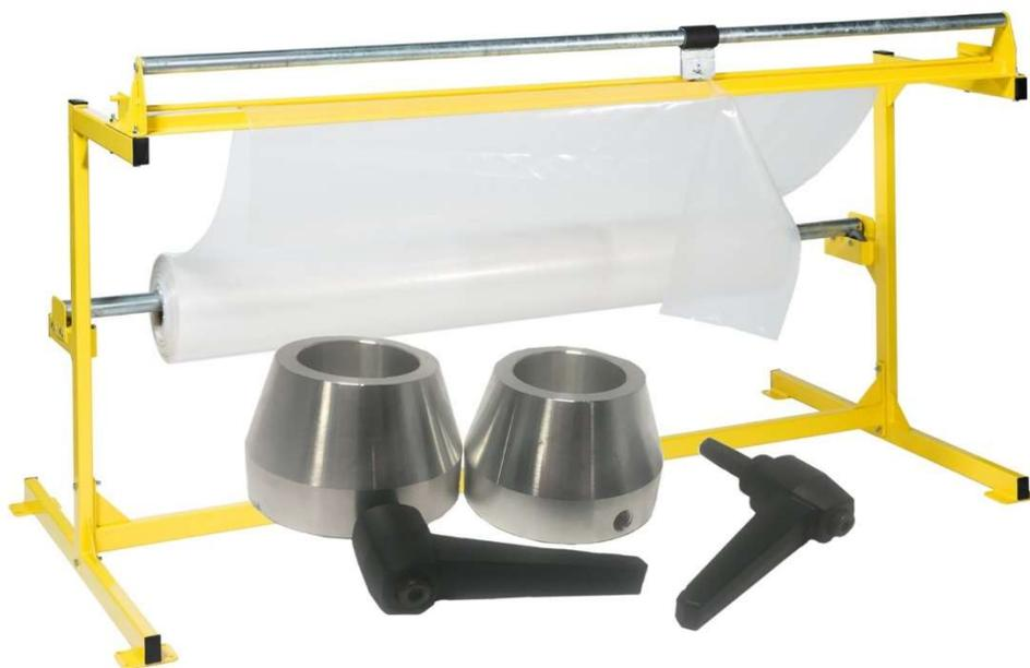
Le FD1/CS-C est équipé de 2 cônes de serrage avec poignée de débrayage qui, fixés de chaque côté de la bobine, la maintiennent sur son axe et facilitent ainsi le déroulement du film.
