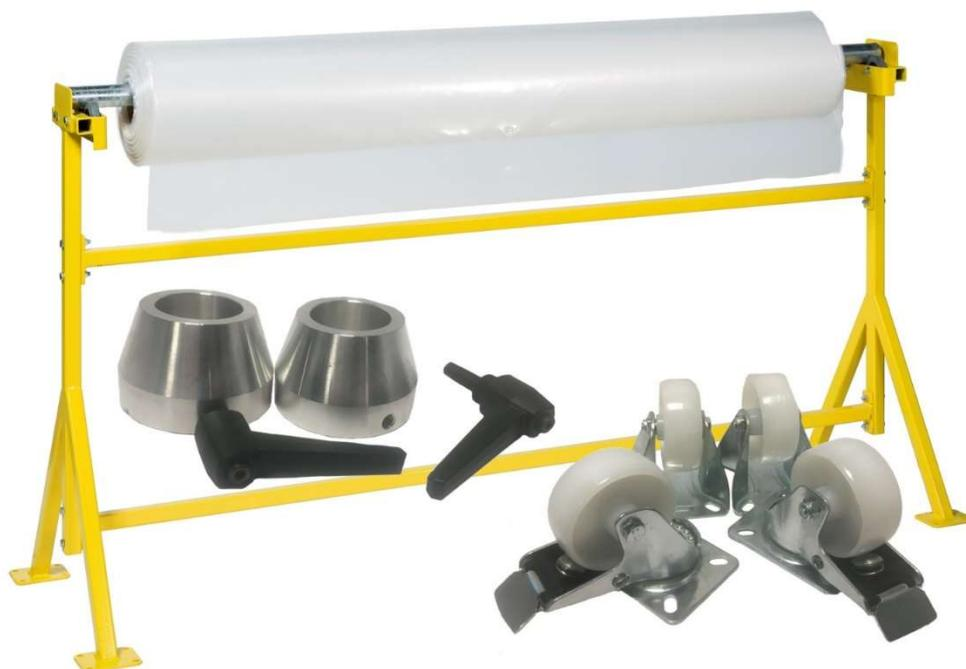
Ce matériel permet de dérouler un rouleau de film à plat, film dossé, ou gaine à palettes ou de housses prédécoupées. Il est constitué de 2 pieds, 2 entretoises horizontales et de 4 roulettes qui permettent de faire tourner l'axe porte bobine. Il comprend aussi de **deux roues mobiles et deux roues fixes ainsi que deux cônes de serrage**.
