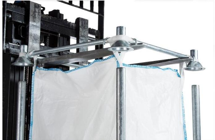
Le MB11-C est un support pour GRVS (Grand Récipient Vrac Souple) qui permet de déplacer les conteneurs souples indépendamment de la structure.
