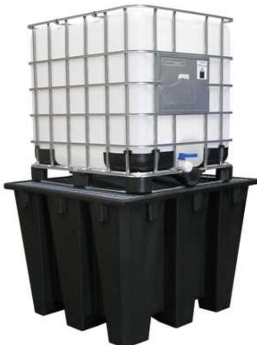
Le BAC1C/ECO est fabriqué en polyéthylène recyclé. Il est équipé d'un caillebotis en acier galvanisé permettant le stockage en rétention d'une cuve de 1000 litres. Il est manipulable à vide avec un chariot ou un transpalette, et, est préhensible des 4 côtés.
