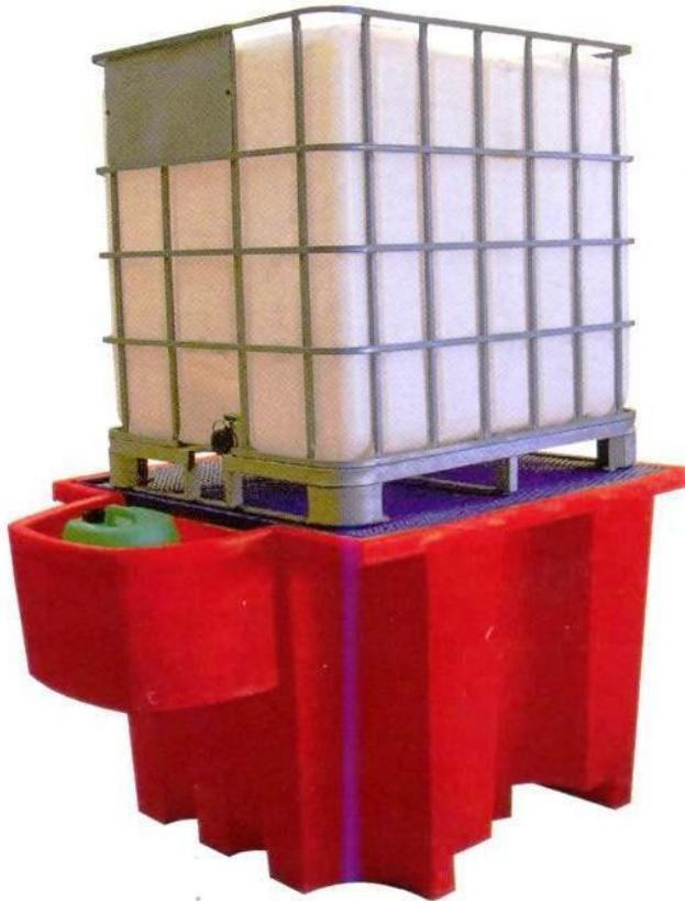
Les bacs de rétention en plastique sont particulièrement adaptés aux acides et bases. 100% polyéthylène, ils regroupent de nombreux avantages : légèreté, facilité de nettoyage, longévité, résistance à la corrosion et aux produits chimiques. Le bac de rétention MRPSOUT1100 possède un réceptacle de soutirage intégré. Utilisation possible sans caillebotis pour certains containers.
